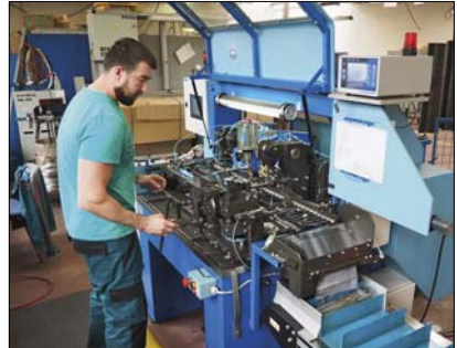
Dráty si v Remerscu vyrábějí sami a specialitou je materiál Duplex ze švédské oceli Sandvik. Dráty vznikají buď s rovinnou, nebo zabnutou hlavičkou a v klasickém či zeslabovaném provedení.
