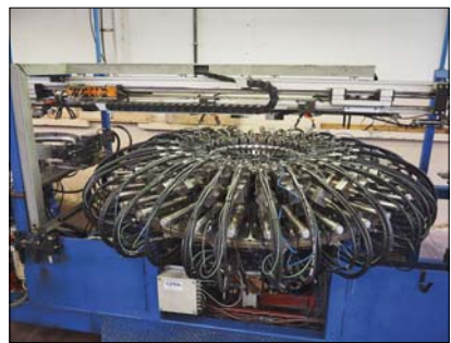
Automatické linky už zvládají spojení ráfku a jeho nastavení přesně podle počtu požadovaných děr, které vytvoří tato soustava vrtáček.
