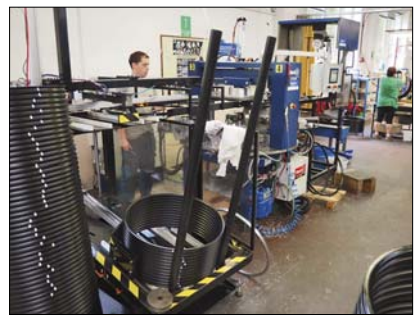
Ráfky s vlepenu duralovou vložkou musí být vybavené samolepkou označující místo spoje, aby si stroj uměl tento spoj najít před navrtáním otvoru pro dráty a ventilky. Ocelové kolíky to řeší magneticky, tady je nutná samolepka.
