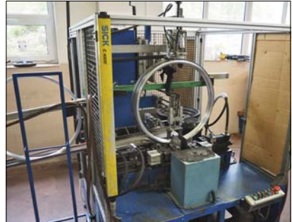
Spojování ráfků ocelovými kolíky je sice spolehlivé, ale přináší to vyšší hmotnost než technologie s lepenou vnitřní duralovou vložkou nebo svařování.
